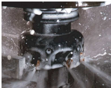
Vysokotlaké chlazení při frézování zabraňuje teplotním šokům na břitových destičkách.
