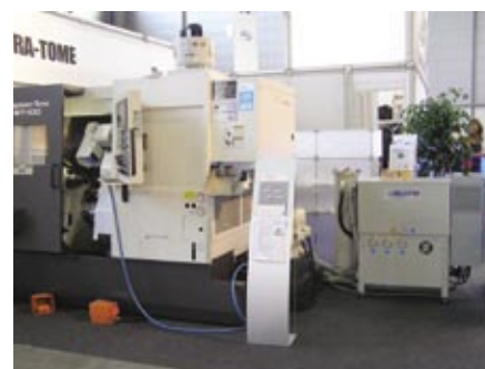
Soustružnicko frézovací stroj Nakamura s „inteligentní“ vysokotlakou jednotkou Chipblaster.
