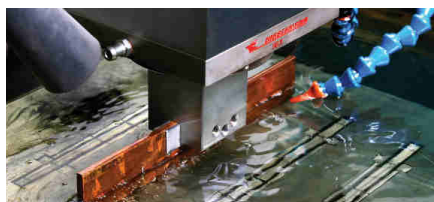
Elektroerozivní hloubení pomocí měděné elektrody
